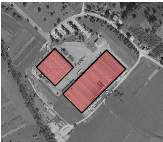
Slika prikazuje možne lokacije za postavitve sončnih elektrarn na strehah podjetja Unior d.d.. Skupna površina je preko 20.000 m 2 .
